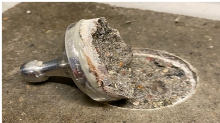
Abbildung 1: Haftzestempel nach Abzug von Betonplatte.
